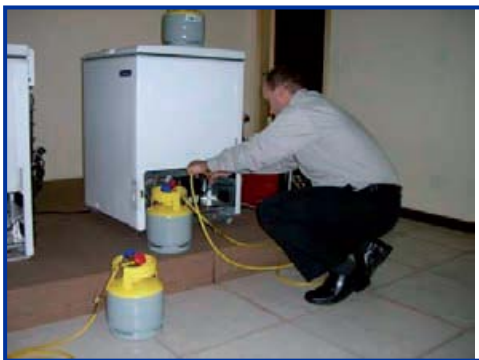
Slika 23: Postavljanje cilindra za prikupljanje
