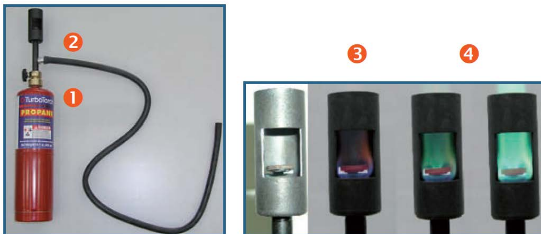
Slika 3: Halidni detektor curenja (zabranjena upotreba u EU)
