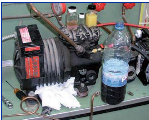
Slika 18: Uzimanje uzorka ulja iz poluhermetičkog kompresora
