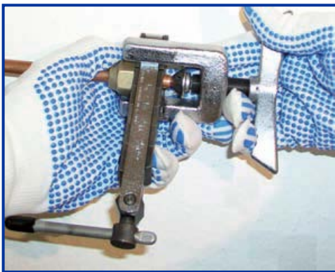
Slika 5: Namještanje alata za pertlovanje
