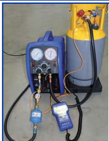
Slika 8: Povezivanje cilindra za prikupljanje i uređaja za prikupljanje sa OFP priključkom
