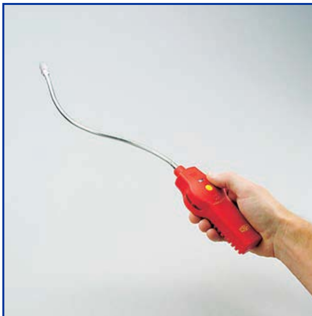
Slika 21: Završni test curenja pomoću elektronskog detektora curenja 2
