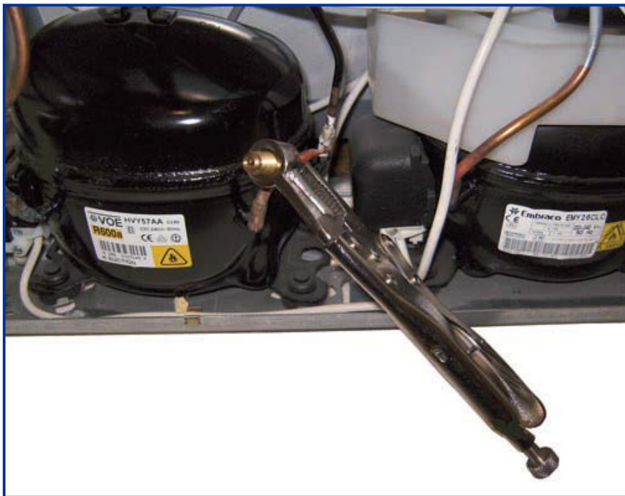
Slika 7: Postavljanje kliješta sa ubodnim priključkom
