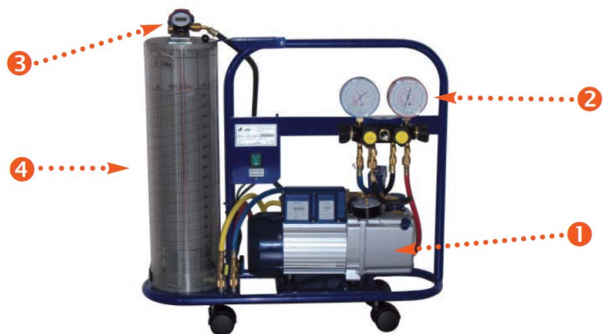
Slika 8: Uređaj za punjenje i vakuumiranje
