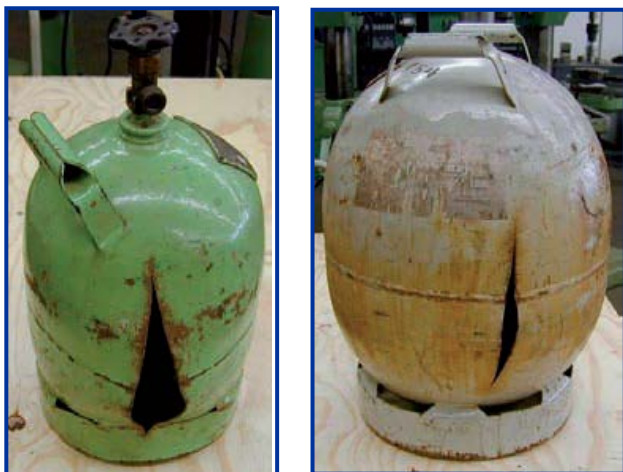
Slika 3: Primjeri cilindara koji su eksplodirali zbog prepunjavanja
