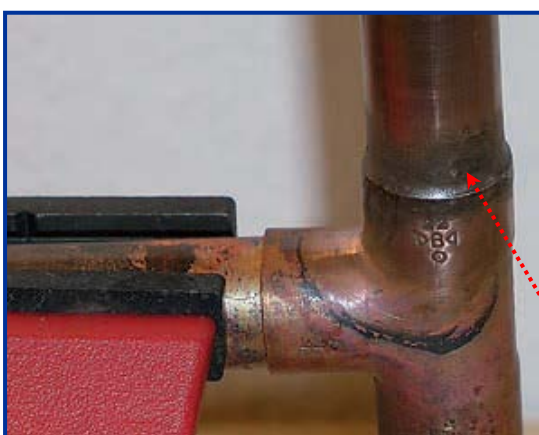
Slika 11: Izgled zalemljenog mjesta
