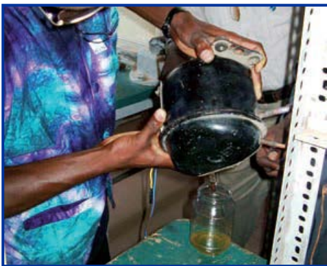
Slika 17: Uzimanje uzorka ulja iz hermetičkog kompresora
